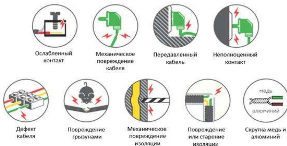
Рисунок 6. Возможные причины искрения в электропроводке
